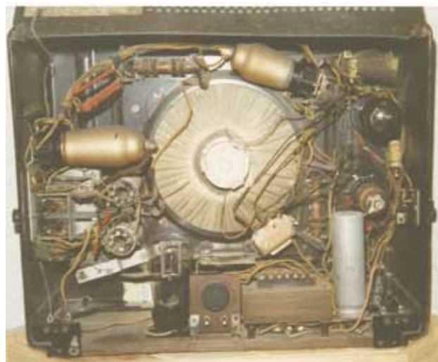
Philips V6 (1936, LG-KG, buizenbezetting: AK2, AF3, ABC1, AL4 en AZ1. Voor afscherming van magnetische en elektrische velden werden geaarde stroken zilverpapier tegen de binnenwand geplakt. (Foto/collectie: auteur).
